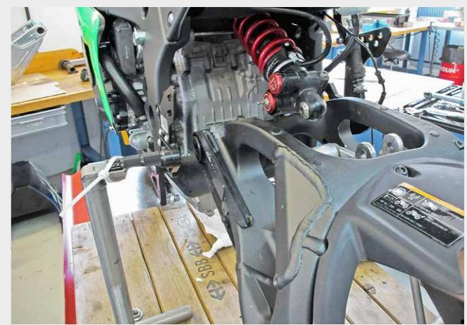
**D** Die OEM-Gewindeglocke muss durch die mitgelieferte Gewindeglocke ersetzt werden.
